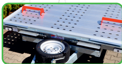
Chowane pod podłogą
